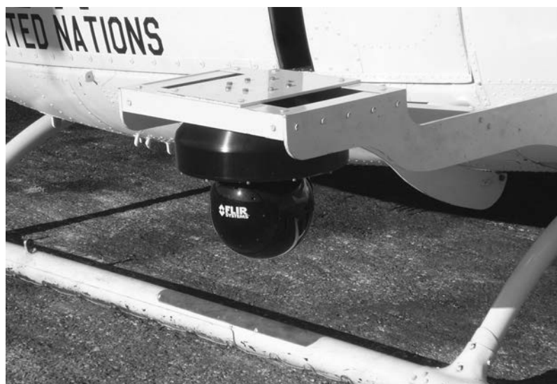
System zur Erstellung eines Infrarotbildes des Vorausgeländes (FLIR – Forward Looking Infrared-Kamera) an einem chilenischen UN-Hubschrauber der MINUSTAH in Haiti. Foto: H. Lixenfeld, mit freundlicher Genehmigung von Dr. Walter Dorn
